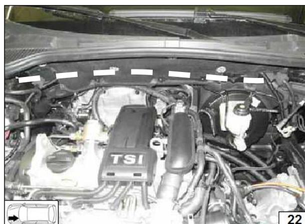
Спустить жгут и трубку 1 в нижнюю часть автомобиля вдоль топливных и тормозных трубок.
