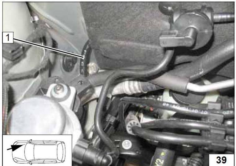
1 Топливопровод и жгут проводов топливного насоса в гофрированной изоляции
