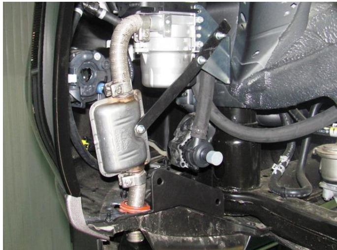
Вырезать в пластике бампера отверстие
