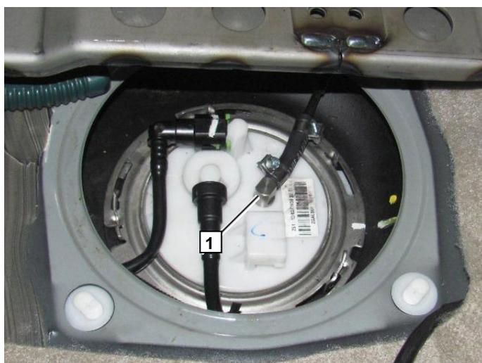
Просверлить отв. Ø6 мм и установить в него болт М6х15 1
