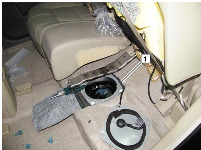
Укоротить топливную трубку топливозаборника 1
