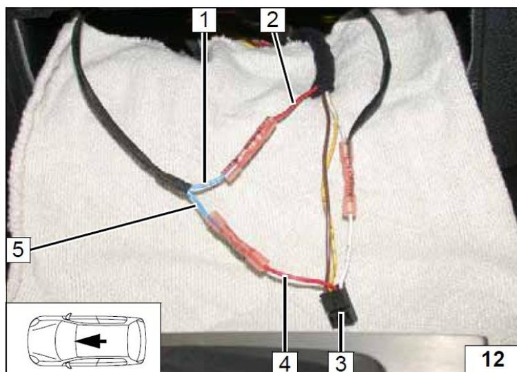
**Подключение к 15 клемме гнезда прикуривателя.**
