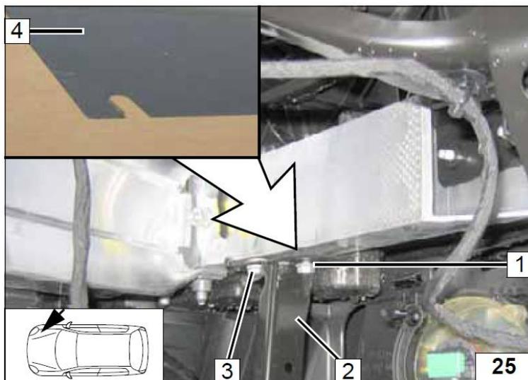
Предварительно закрепить отопитель срезанным отверстием кронштейна **1** между штатным кронштейном **3** и бампером.
