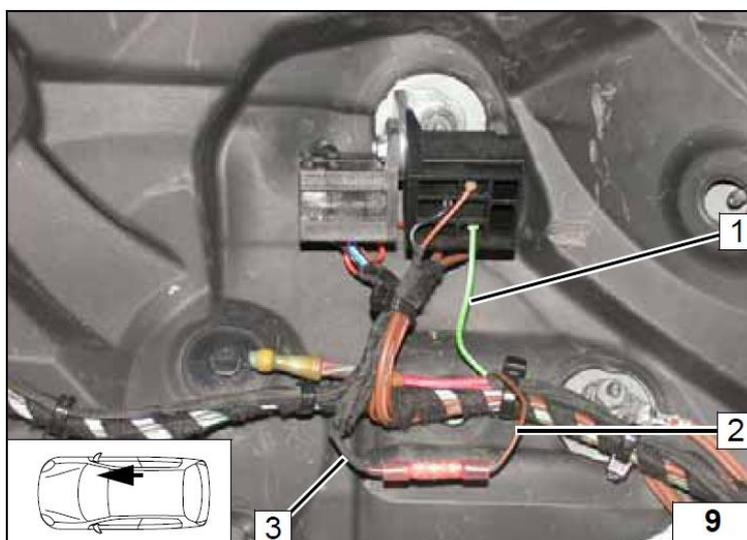
Жгут проводов для подключения климат-контроля **3** проложить вдоль штатного жгута и закрепить кабельными стяжками.
