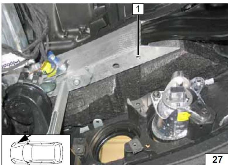
Закрепить отопитель срезанным отверстием кронштейна между штатным кронштейном и бампером.
