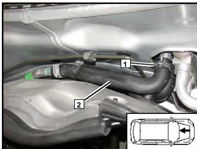
Сжать штатный пружинный хомут **1** и снять «горячий» шланг **2** с переходного штуцера **3**
