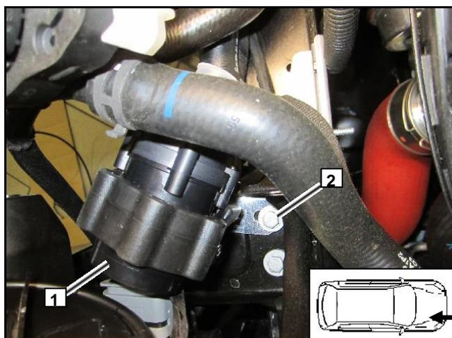
Развернуть циркуляционный насос 2 в креплении таким образом, чтобы его выходной штуцер 1 был направлен на провод массы 3
