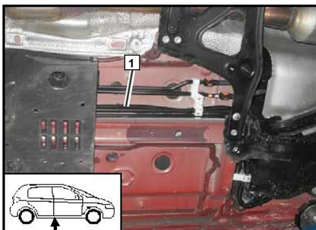
1 Топливопровод и жгут насоса-дозатора в гофрированной защите кабеля Ø 10 мм
