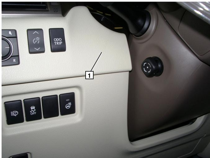
1 Расположение колодки предохранителей и реле.
