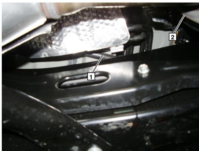
Снимите топливный насос **2** в соответствии с инструкцией производителя.
