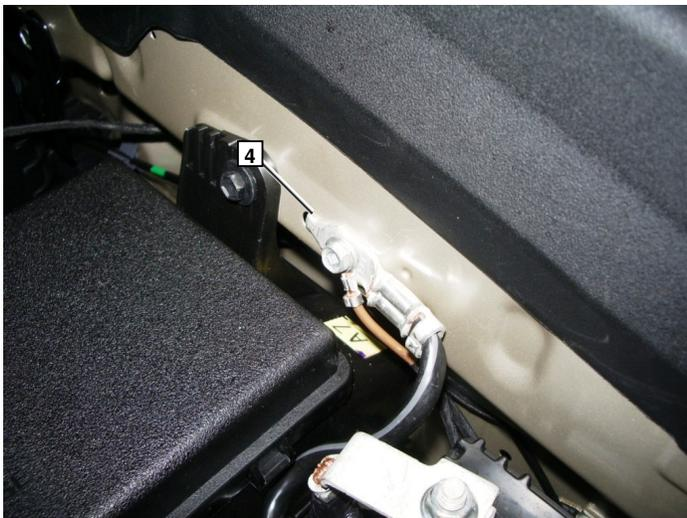
Жгут проводов к органу управления и силовые провода для подключения мотора вентилятора 1 салона проложить вместе с топливной трубкой и жгутом проводов на насос дозатор по левой стороне моторного отсека, к моторному щиту.
