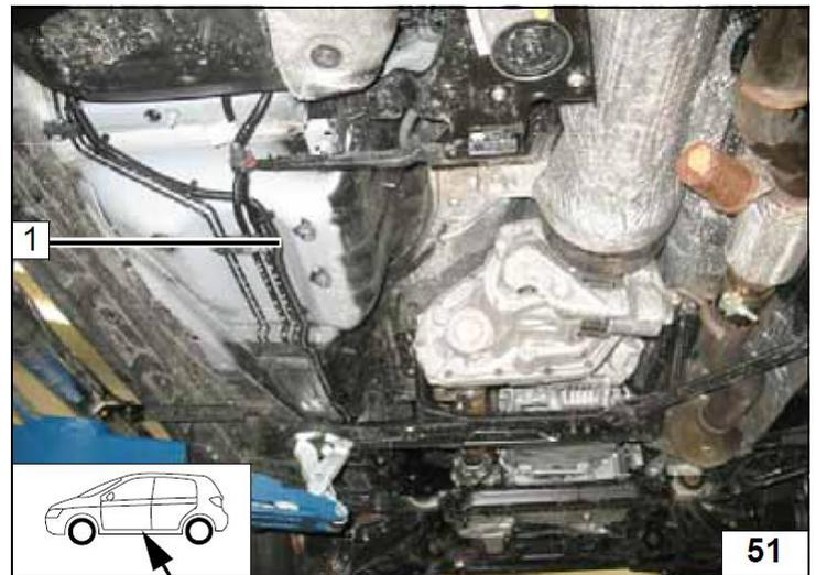
1 Топливопровод и жгут проводов топливного насоса в изоляции
