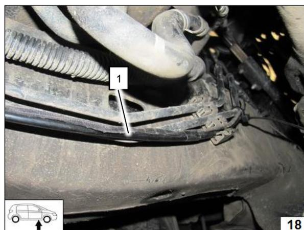
Подключить топливозаборник в трубку подачи топлива (имеет больший диаметр).
