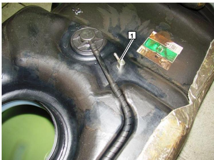
1 Топливозаборник, подогнуть по месту, выдержать зазор до дна бака 25мм
