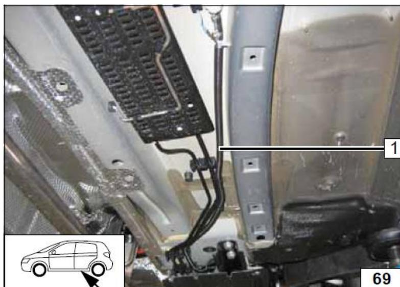
Удалить штатную гайку в поз 1 и вместо неё установить дистанционную гайку 2 М6 + шайба большого диаметра.
